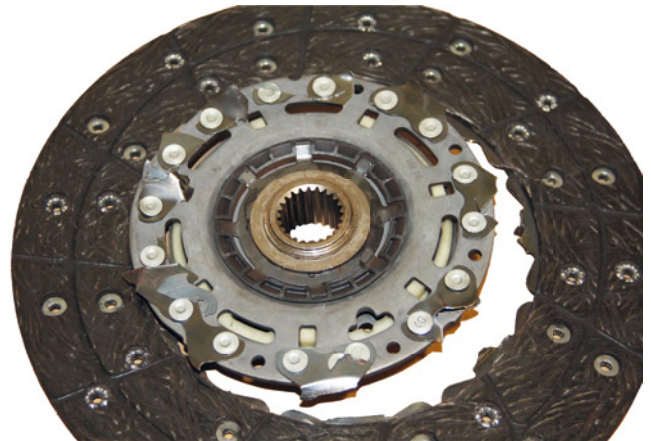
Image 2 : Moyeu du disque d'embrayage désolidarisé de la partie friction
