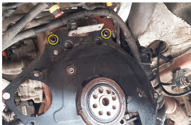
Immagine 1: Perna di allineamento sul monoblocco
