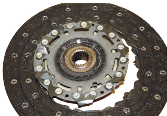
Immagine 2: Mozzo del disco della frizione rotto
